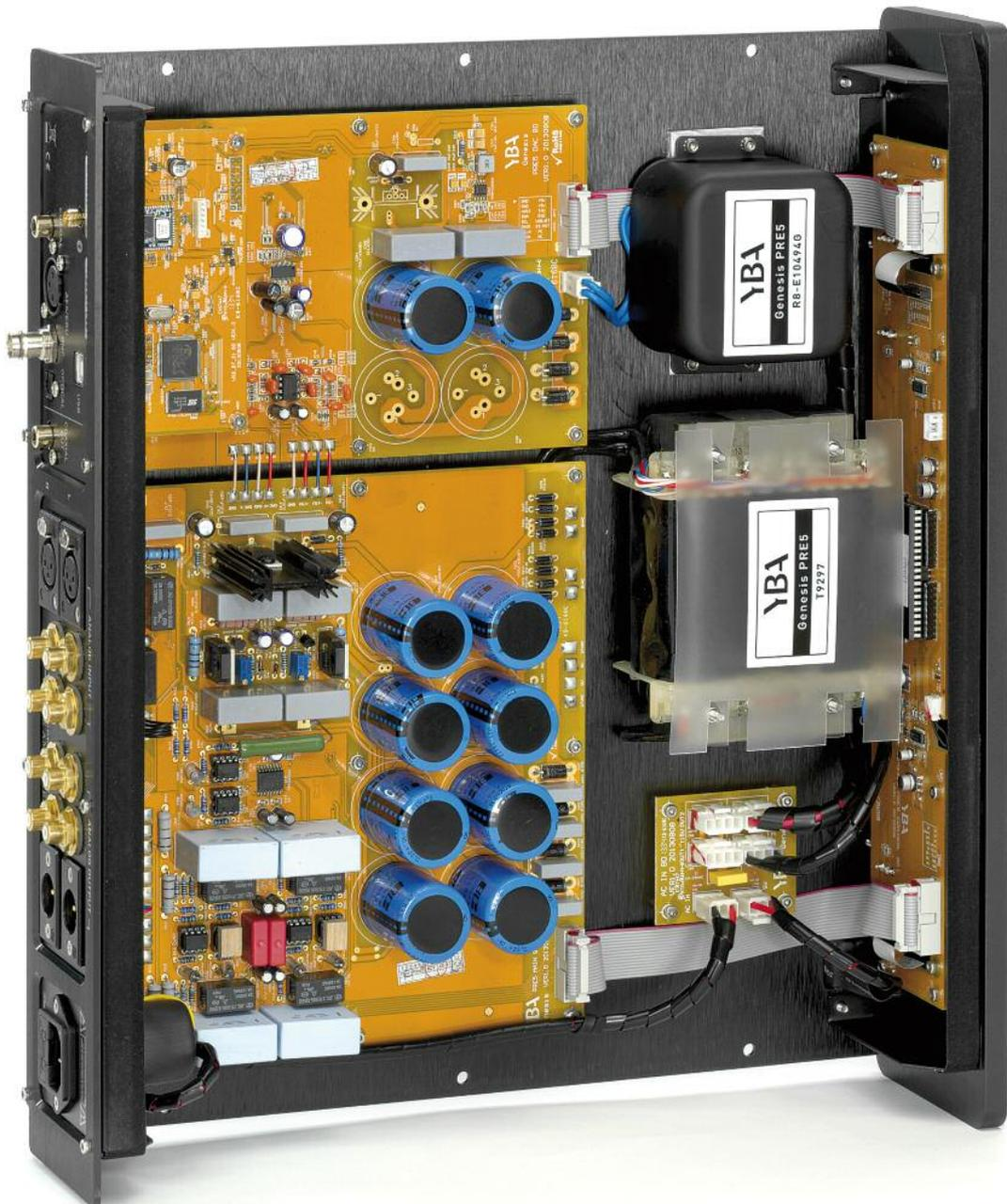
Die Vorstufe beinhaltet neben der analogen Vorstufe (untere Platine) auch eine aufwendige, 24 Bit/192 kHz-fähige Wandler-Sektion (Platine oben)
