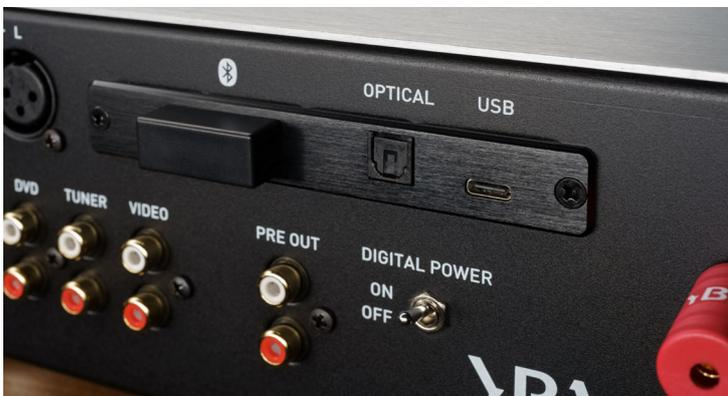
Die digitale Sektion bietet kabelgebunden einen optischen S/PDIF-Input und einen USB-C-Port. Hierüber ist die Zuspieldung von HiRes-Files bis PCM 384 und DSD256 möglich. Links ist das Bluetooth-Modul erkennbar. Der A200 hat eine integrierte Antenne, durch die eine größere Übertragungsreichweite erreicht wird. Mit dem unten zu sehenden „DIGITAL POWER“-Schalter kann man die Stromversorgung der Digitalsektion abschalten. So wird eine etwaige Beeinflussung der Analogsektion verhindert.
