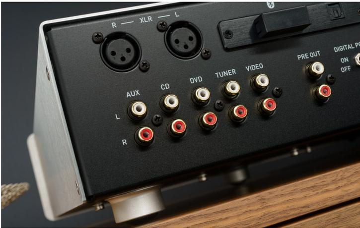
Die analoge Eingangssektion: Hier punktet der A200 mit einem symmetrischen und fünf unsymmetrischen Eingängen. Beim „Video“-Eingang kann zudem die Vorstufe des A200 umgangen werden. Rechts ist noch der Pre Out zu sehen, an dem das Signal der Vorverstärkerstufe abgegriffen werden kann - etwa zur Speisung von Aktivlautsprechern.
