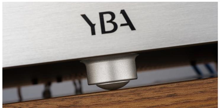
Der frontseitige Fuß ist mit einer Metallkugel an den Boden angekoppelt. Hierüber werden gezielt Vibrationen abgeleitet. Die beiden hinteren Füße hingegen sind mit einer Kunststoffkugel versehen, die Schwingungen dämpft und absorbiert.
