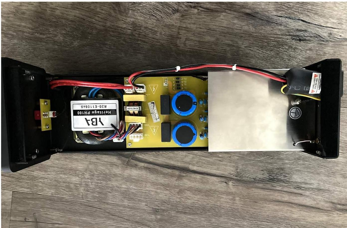
*Am offenen Herz: Der eigentliche Phonoverstärker ist versteckt unter der Blechabschirmung rechts. Der Rest ist Netzteil. Ganz links der R-Core-Trafo.*
