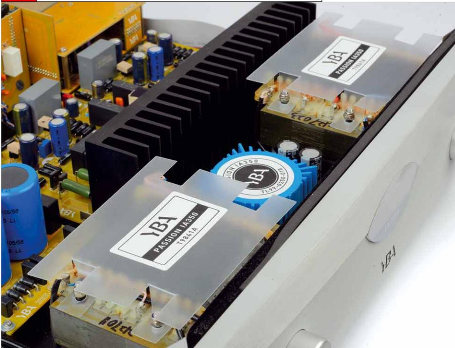
Kanalgetrennte Transformatoren für den Analogteil, dazu ein Zusatzauftrafo für die Digitalsektion
