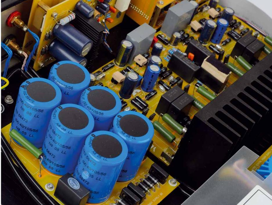
Im Vordergrund sehen wir die Siebung des Netzteils, dahinter die sauber aufgebaute Platine der Endstufe
