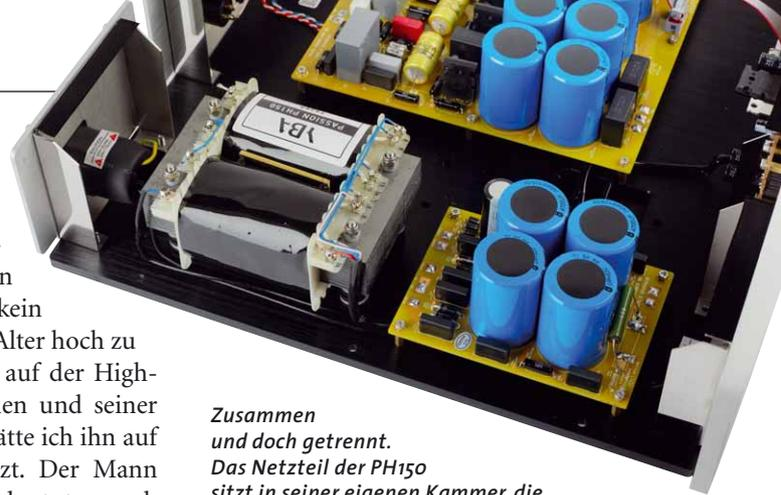
*Zusammen und doch getrennt. Das Netzteil der PH150 sitzt in seiner eigenen Kammer, die mit dem Gehäuse verbunden ist: clever*
