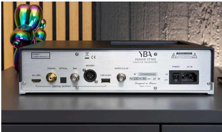
Mit der HDMI-Verbindung genießt man eine vollkommen native DSD-Wiedergabe. Doch auch jede andere gängige Digitalchnittstelle wird am YT302 geboten.
