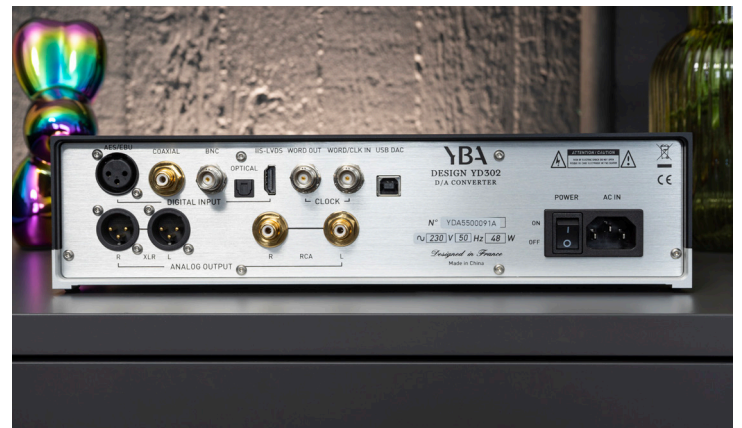
Auch der DAC geizt keineswegs mit Anschlüssen. Das schließt sogar die Verbindung für Word Clocks ein. Dabei kann der YD302 entweder Geber oder Empfänger eines Taktungssignals sein, um die Signalverarbeitung aller Geräte zu synchronisieren.
